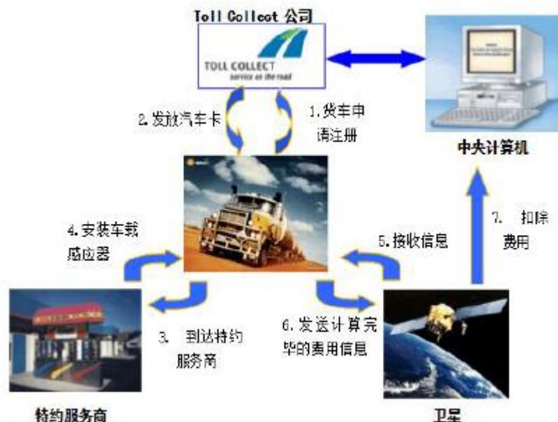
图表44: 德国高速收费系统运行流程
