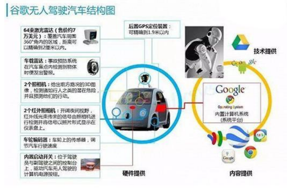
图表23: 谷歌无人驾驶汽车结构图
