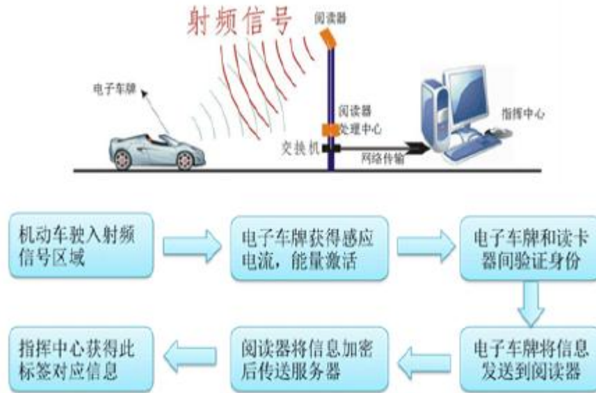
图表34： 电子牌照工作原理示意
