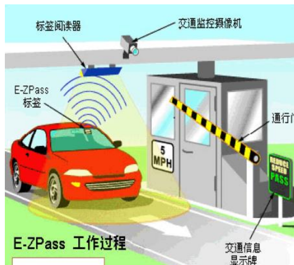
图表42：E-ZPass 收费系统工作原理
