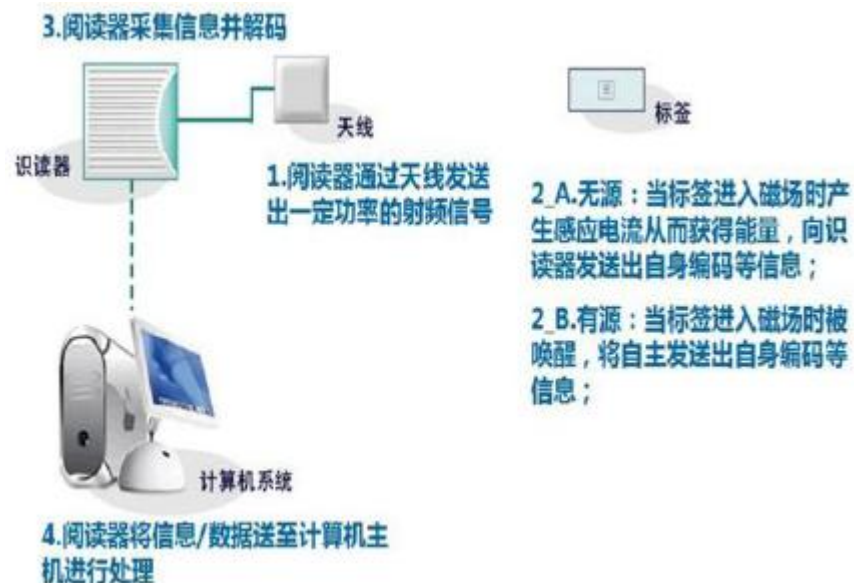
图表35： RFID 工作原理
