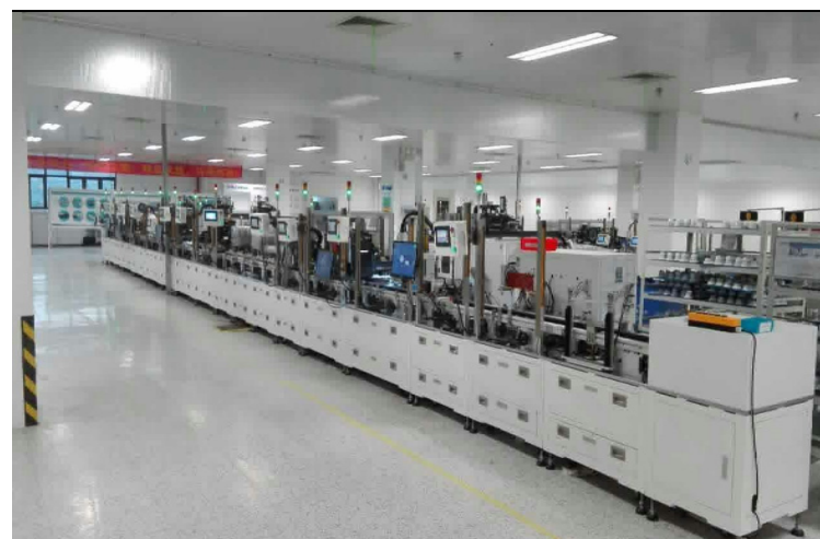
图 18：连硕科技-LED 照明产品自动化生产线
