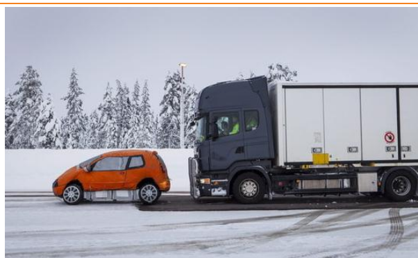
图 60：重卡安装 AEB 系统
