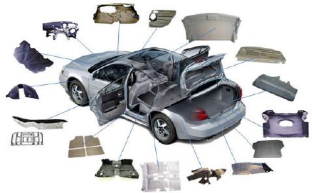
图 2：公司隔音器在汽车中的应用
