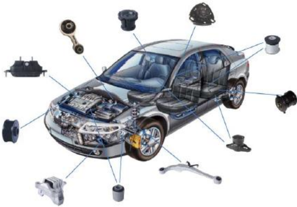
图 1：公司橡胶减震器在汽车中的应用
