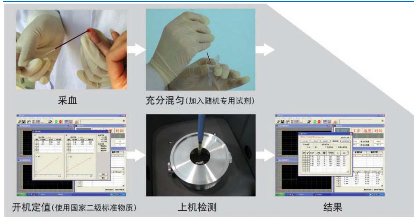
图 13：公司微量元素检测系统的检测操作流程
