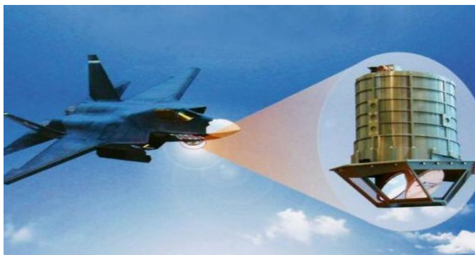
图 25: EOTS-86 机载光电搜索系统
