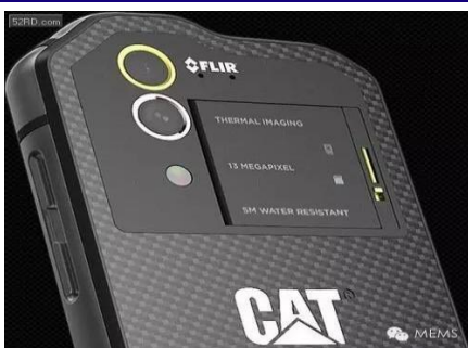
图 14: 集成红外热成像功能的智能手机
