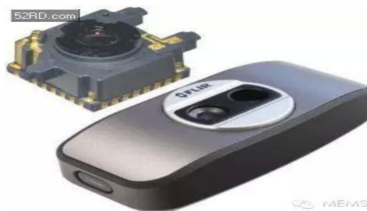
图 15: 第二代 FLIR One 及 Lepton 3 核心组件
