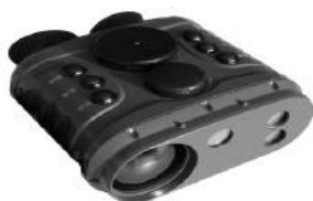
图 26: 公司的便携式多功能非制冷红外侦察仪
