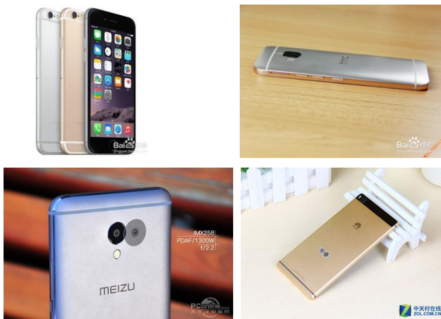
图 2-10：金属机身智能手机的后盖使用开槽设计
