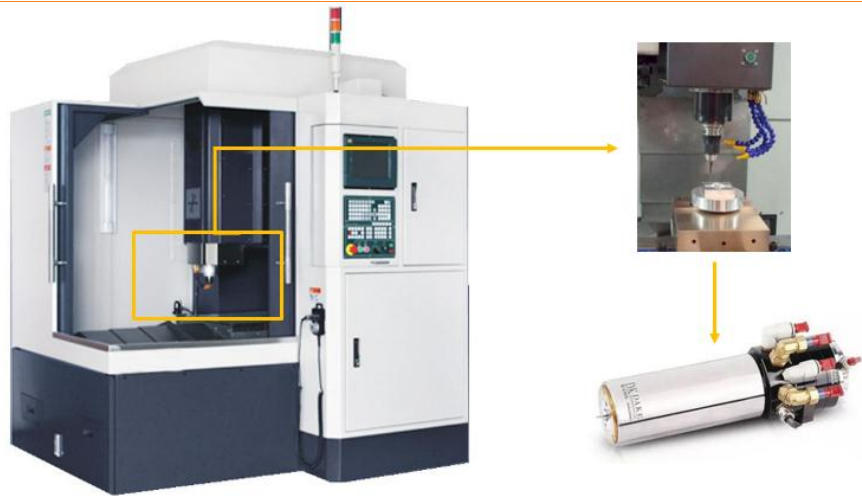
图 9：电主轴在数控雕铣机上的位置
