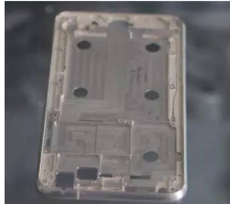
图 10：金属中框通过一整块航空铝经 CNC 加工而成，结构复杂
