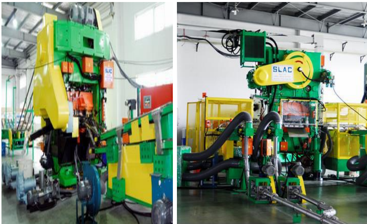
图表 7 公司高速易拉盖组合盖、易拉盖基础盖生产设备示意图
