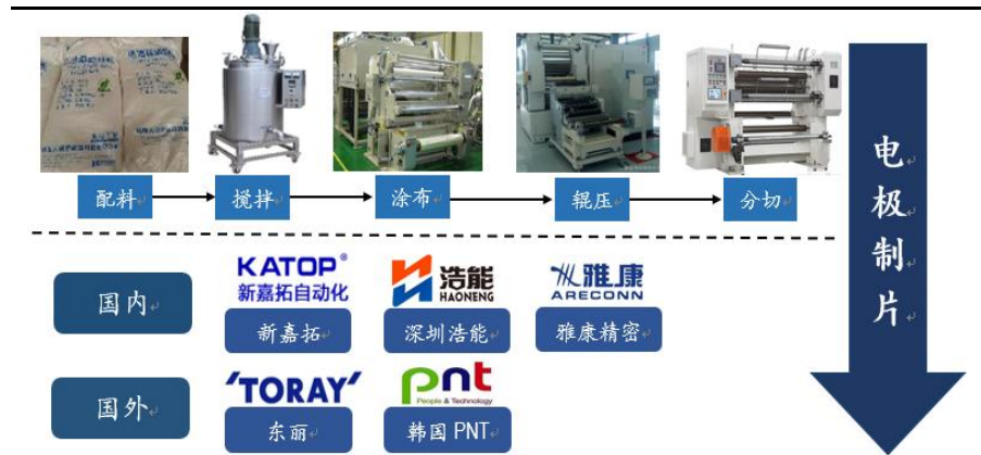
图表 28：前道设备流程图：电极制片的过程
