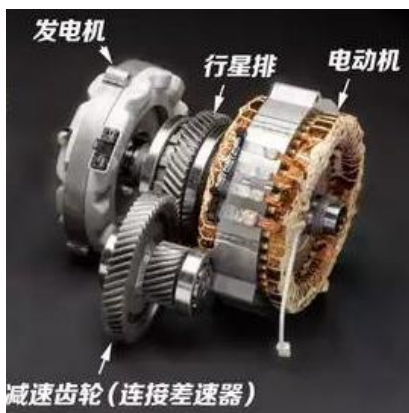
图 17、丰田普锐斯将电机与减速机集成
