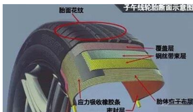
图 3-2：车用子午线轮胎断面结构
