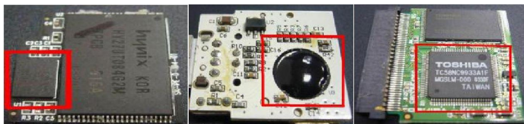
图 1-11: BGA、COB 和 TSOP 封装
