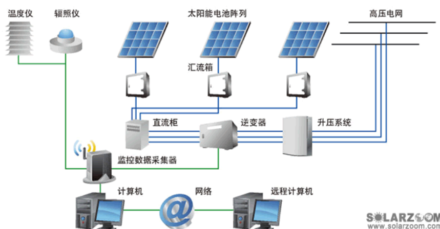
图 2-10：光伏电站并网施工工艺
