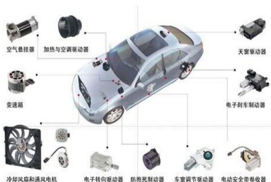
图表 26：电机在汽车上应用示意图
