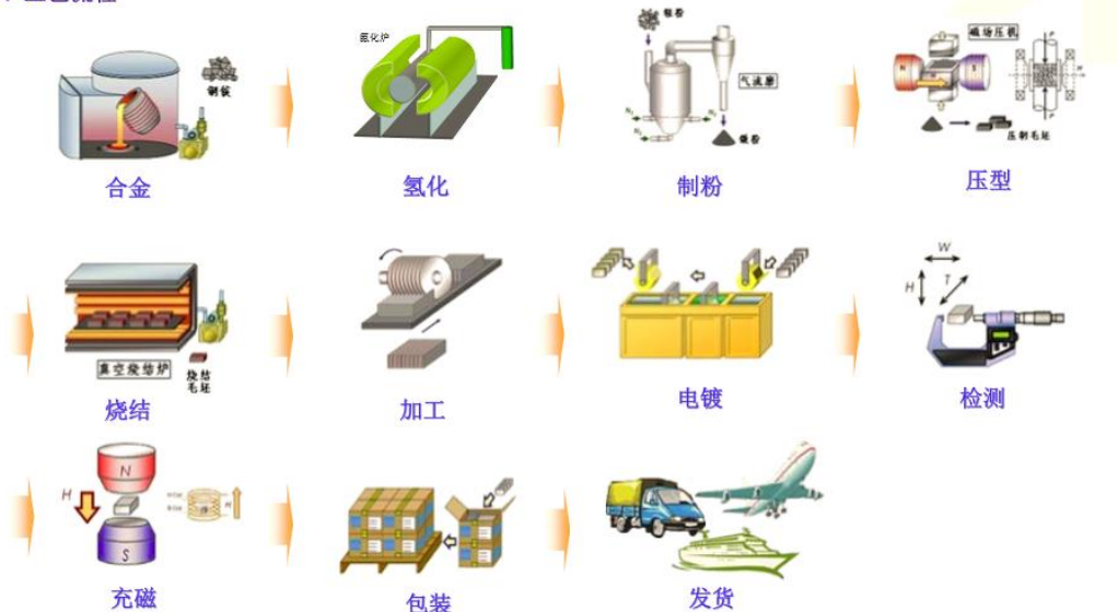
图表 18：烧结钕铁硼生产流程
