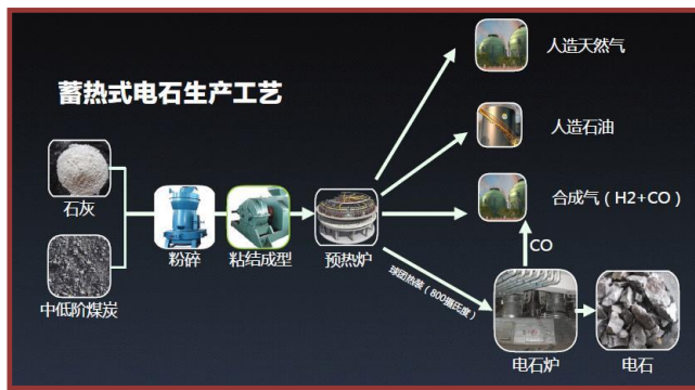
图 11：蓄热式电石生产新工艺
