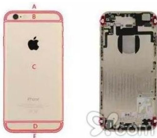
图表 17：金属手机后盖有明显的天线条，影响整体美观
