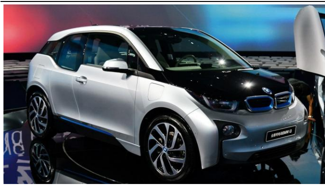
图 61: 新能源汽车宝马 i3 采用碳纤维轻量化车身
