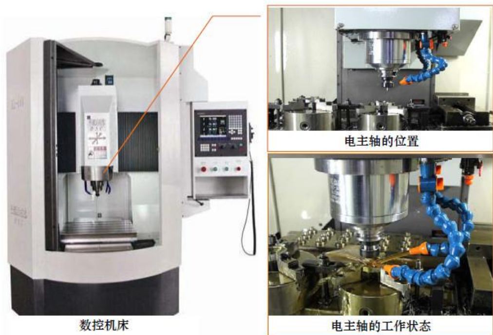
电主轴在数控机床中的位置与工作状态
