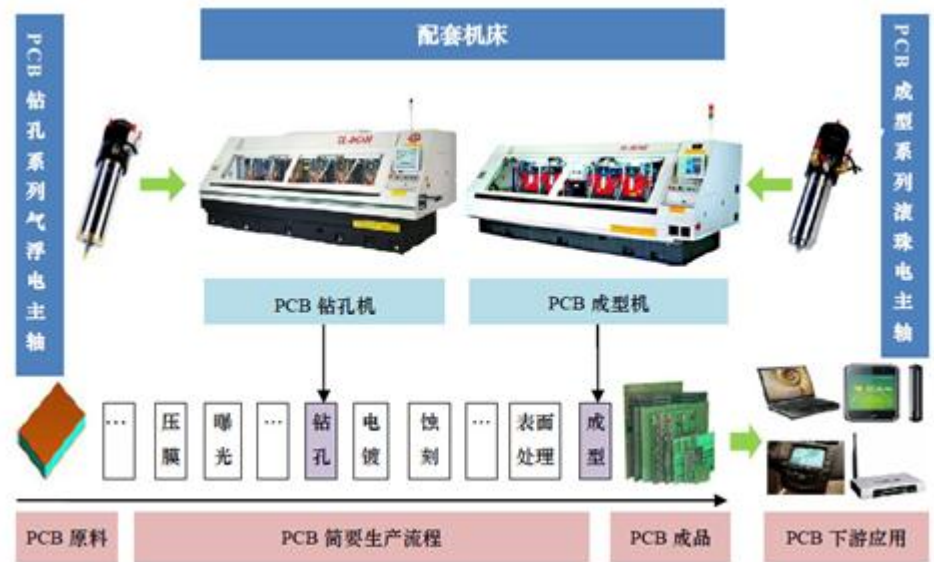
图表11 PCB 钻孔机和成型机电主轴在 PCB 行业中的应用示意图
