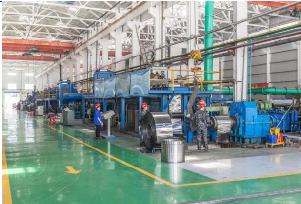
图 19: 九天自主设计立式高效预镀镍热处理一体化产线
