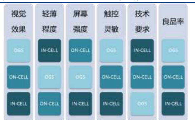
图 39: OGS、In-cell、On-cell 技术优势比较
