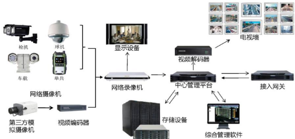
图 15: 公司视频监控系统主要架构
