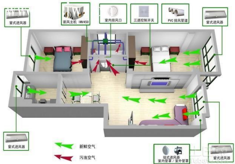
图 11：家庭新风系统原理及所需设备图示
