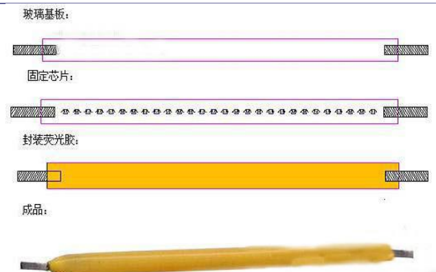
图表 30: 灯丝灯灯丝制作工序
