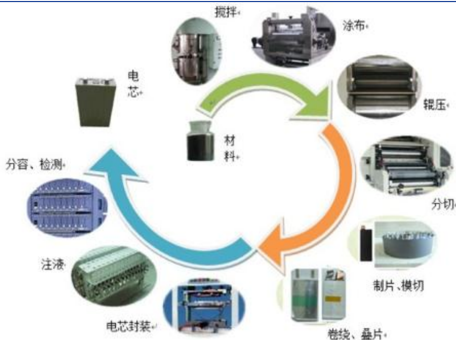
图 14：锂电池生产流程图
