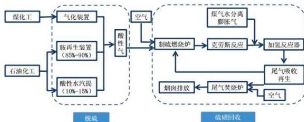
图 9: 硫磺回收工艺流程图
