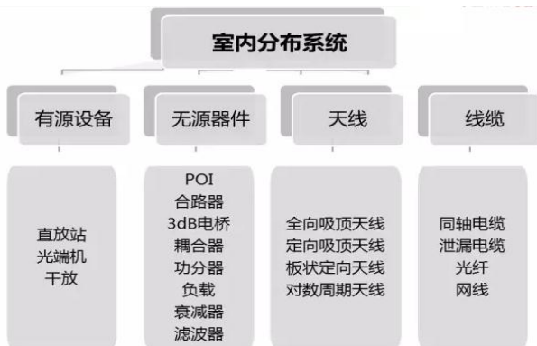
图 17：室内分布系统构成要件
