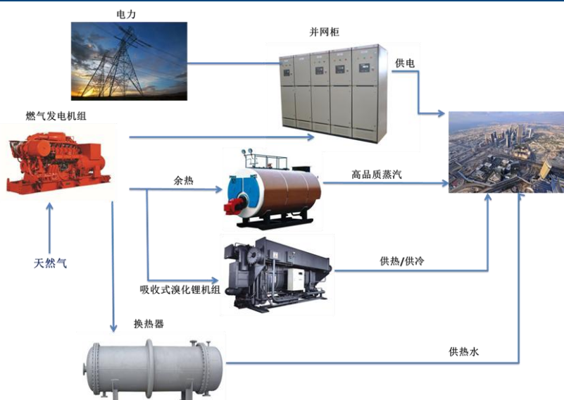
图 27：天然气分布式能源（热电冷三联供）系统示意图
