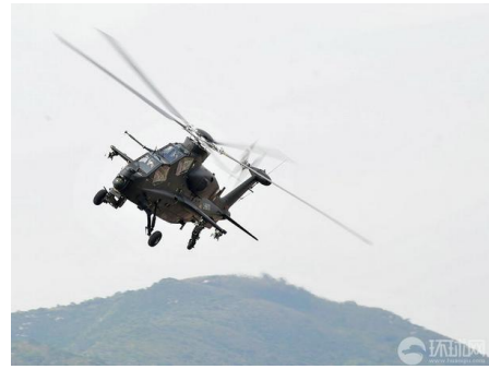
图 37: 装备涡轴 9 发动机的武直十, 功率 1000kw 级别
