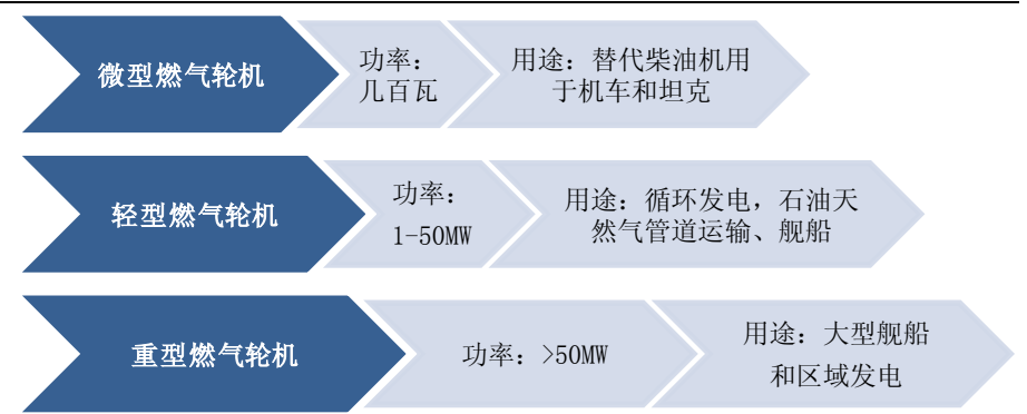
图 24: 燃气轮机应用广泛,可用于舰船、发电、天然气等管道运输、机车坦克等领域
