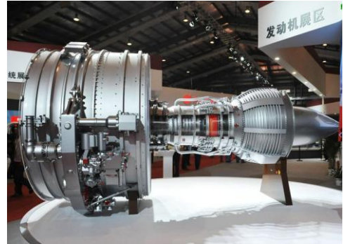
图 35: WS20 发动机, 性能优于目前运-20 装配俄罗斯 D-30KP2 发动机
