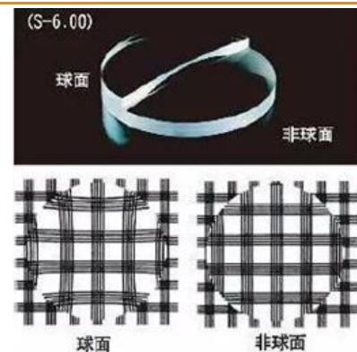
图 8：球面与非球面镜头成像对比
