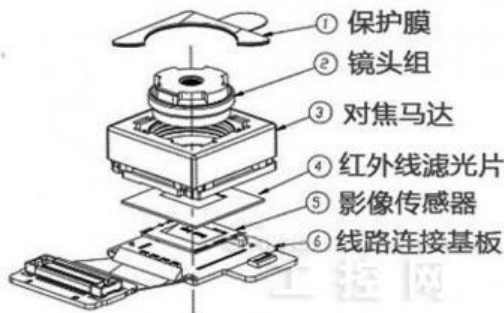
图 5：摄像头主要结构部件
