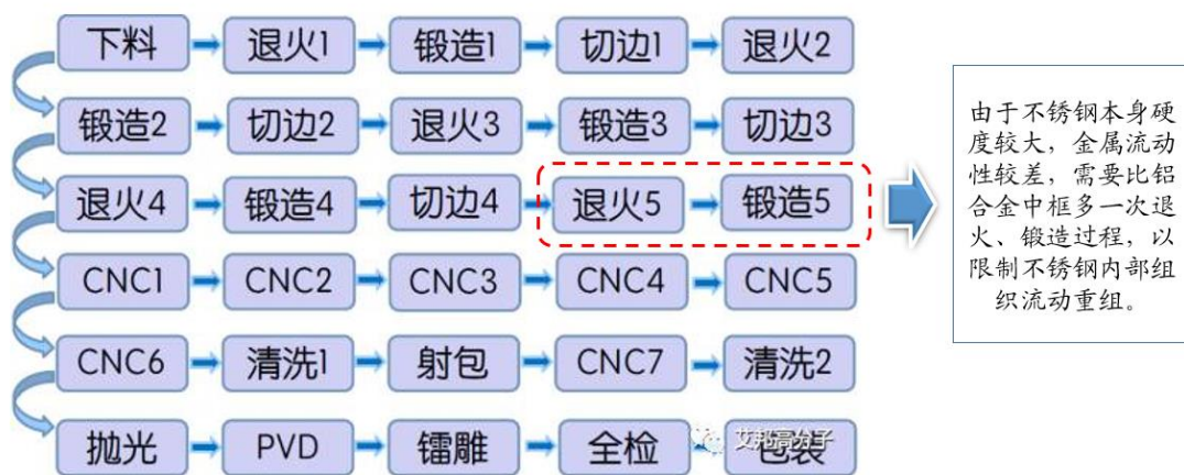
图表 17: 小米 6 不锈钢金属中框加工包含 30 道工序
