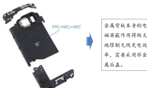
图表 9: 无线充电要求手机采用非金属后盖
