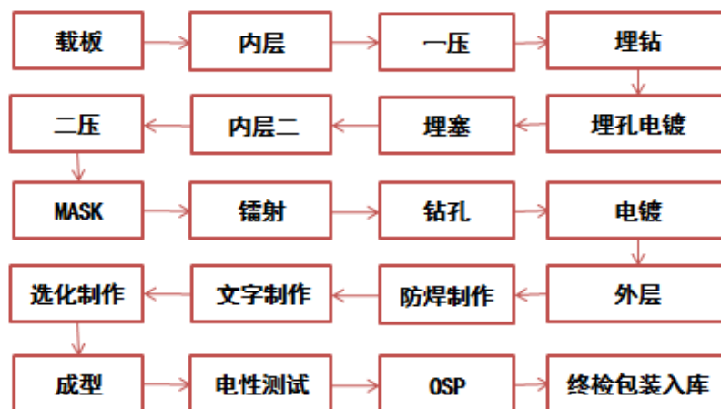
图 16: HDI（二压一阶六层板）制作流程
