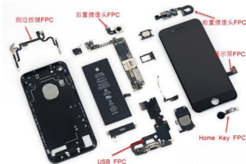
图 29：手机上应用的 FPC 软板
