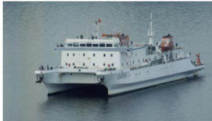
我国首艘千吨级小水面线双体船“北调991号水声测量船”
