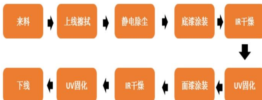
图 32：UV 涂装工艺流程
