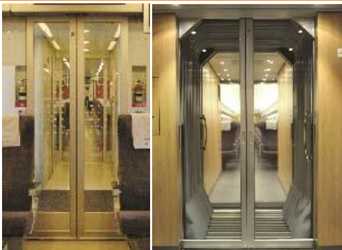
图 2：电控电动移门(应用于动车组内、外端门)
