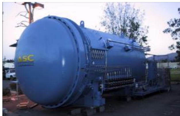
图 17: 热压罐加压固化后层间结合紧密，机械强度优
