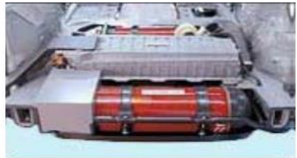
图 40：单个压缩气罐碳纤维用量为 10-20Kg
