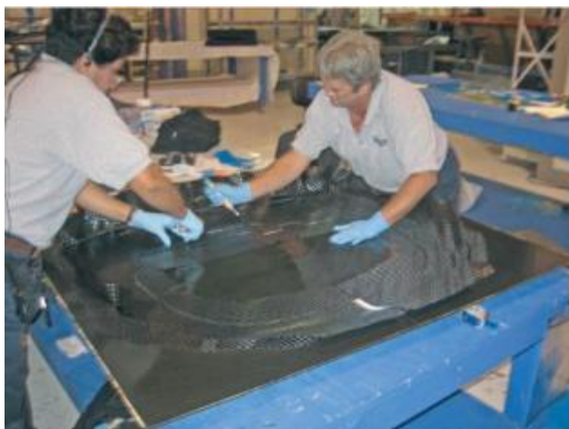
图 16: 手工铺层最大好处是树脂和纤维含量可控
