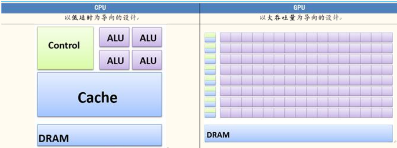
图表 9：CPU 是基于低延时的设计而 GPU 是基于大吞吐量的设计
