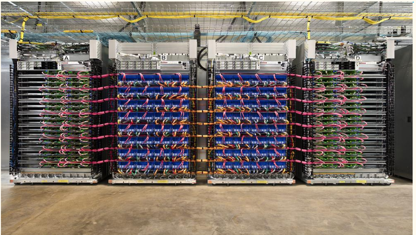
图表 18: 用 64 个第二代 TPU 构建的“TUPPOD”, 可以提供 11500 万亿次/秒浮点运算能力
