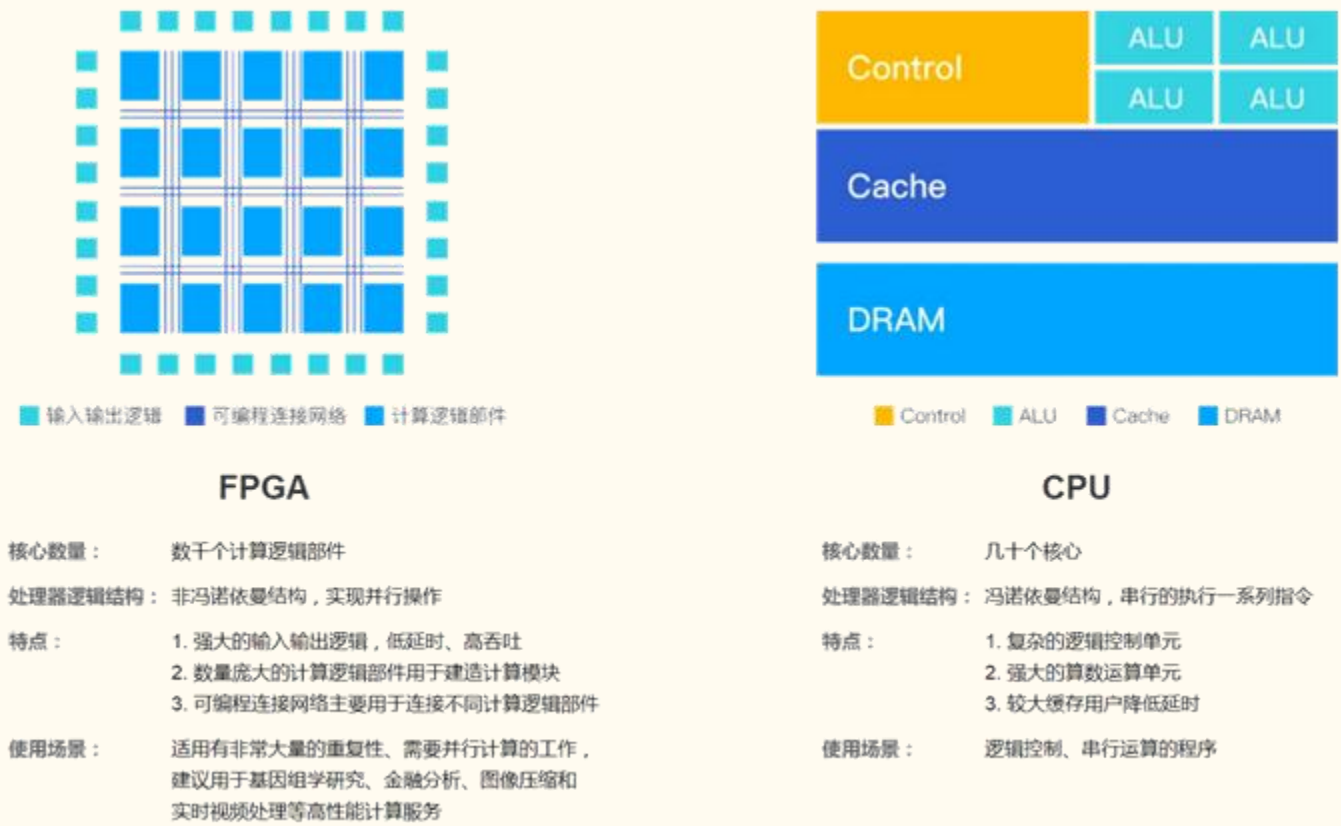
图表 16：FPGA 与 CPU 在处理器逻辑结构、特点、使用场景方面的对比
