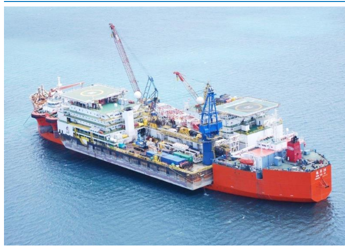
图 29：半潜运输船在运送海工装备
