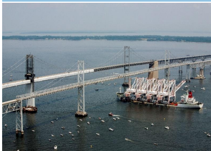
图 28：整机运输船运送美国巴尔迪摩桥吊通过切萨皮克海湾大桥
