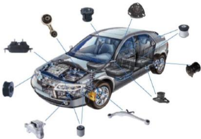
图 1：橡胶减震产品在汽车中的分布
