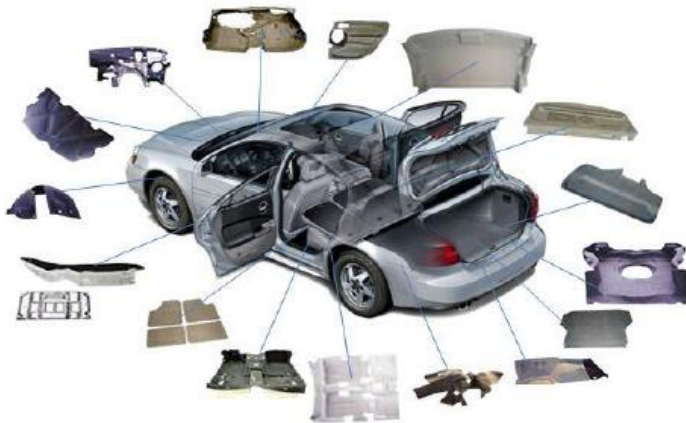
图 6：隔音产品在汽车中的分布
