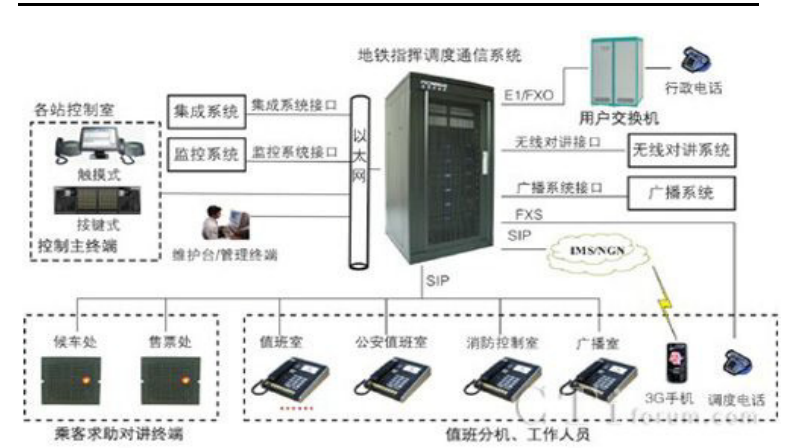
图 21: 地铁指挥调度通信系统组网
