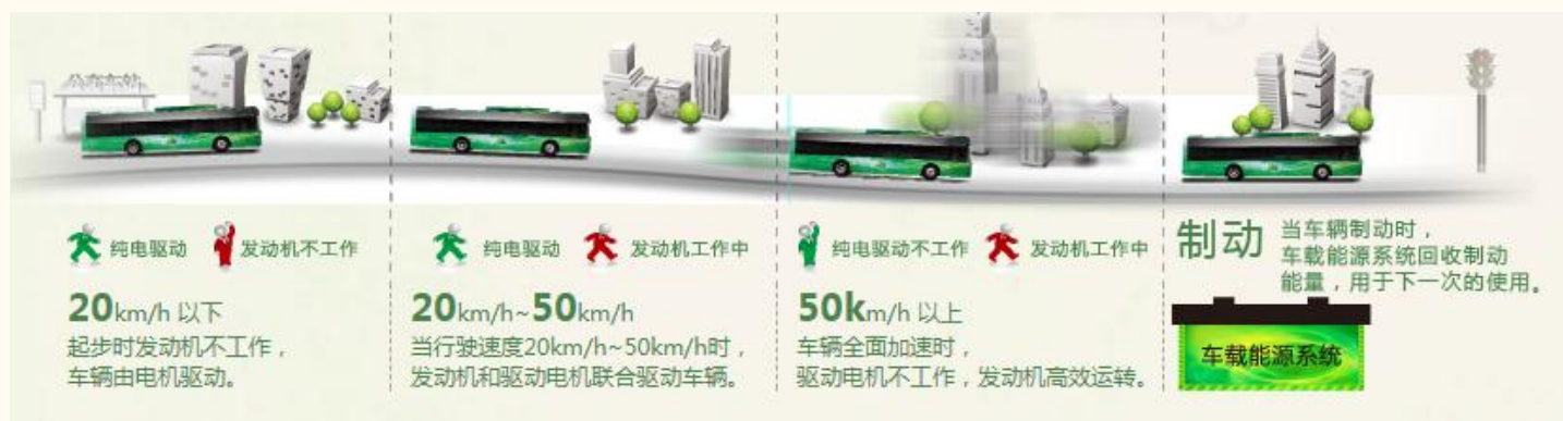
图表 52：混合动力及插电式混合动力车型中睿控技术的工作原理
