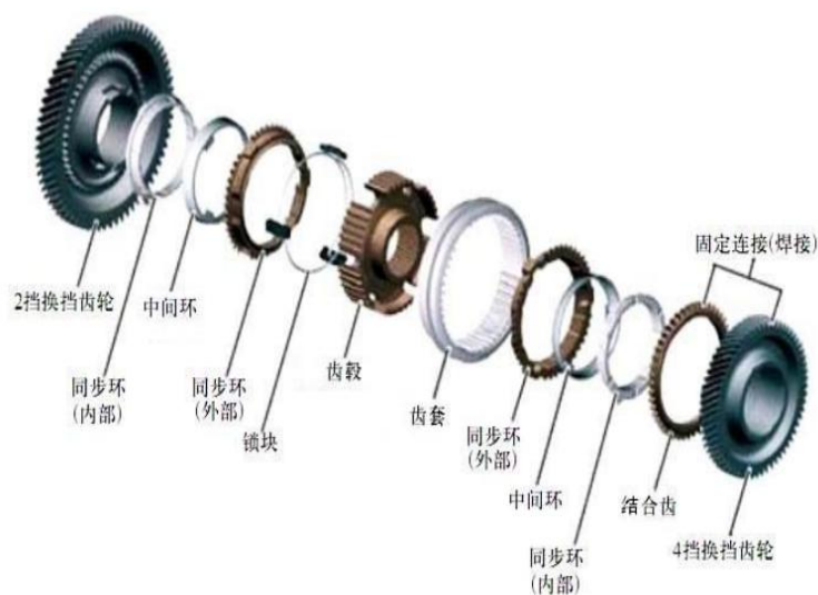
图 1 汽车变速器用同步器主要构成
