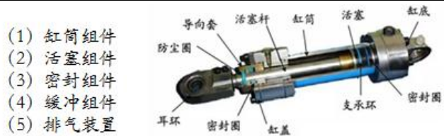
图表 16. 液压缸由五个部分组成
