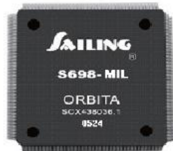
图表 29: S698-MIL (32 位高可靠高性能 SOC 芯片)
