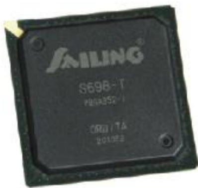
图表 28: S698-T (高性能测控设备专用 SOC 芯片)
