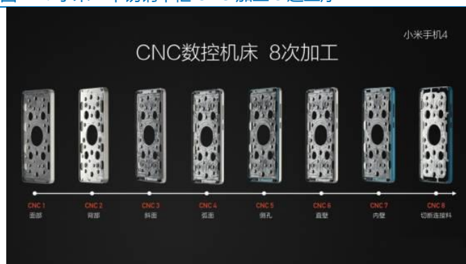
图 17：小米 4 不锈钢中框 CNC 加工 8 道工序
