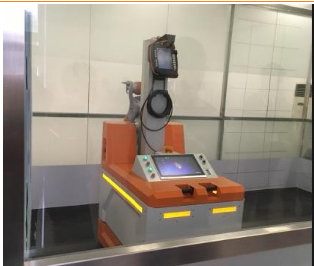
图 5：智能移动装饰放线机器人 3
