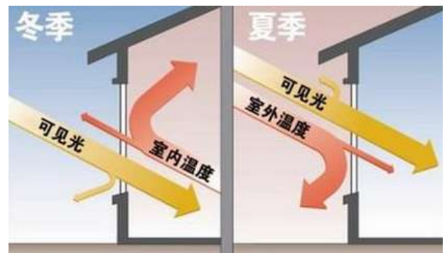
图 24: Low-E 玻璃冬季、夏季节能作用原理
