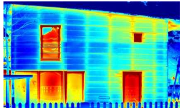
图 36: 玻璃门窗是建筑热散失的主要通道
