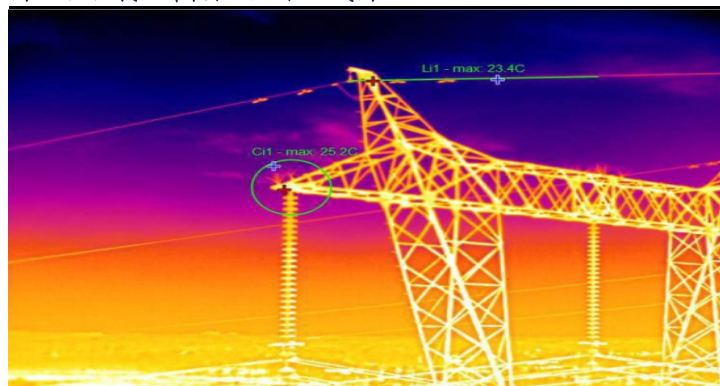
图 12: 搭载红外相机无人机巡线图
