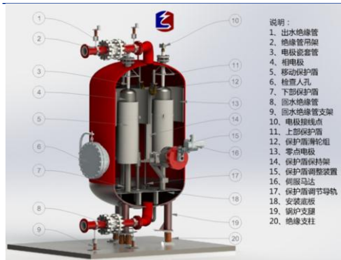
图 13：技术路线一：非储热式高压电极锅炉
