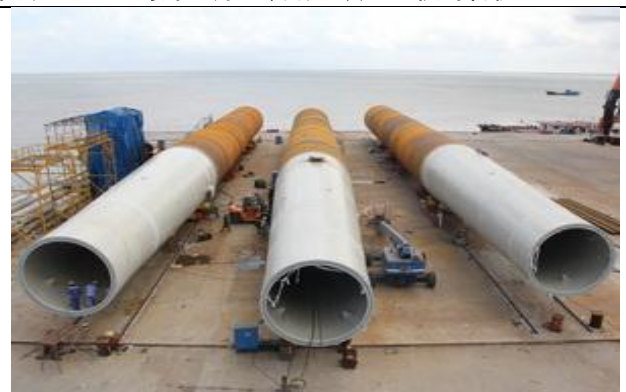
图表13 蓝岛海工为三峡响水项目提供的管桩
