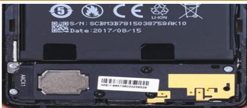
图 12：小米 MIX 采用 LDS 天线工艺
