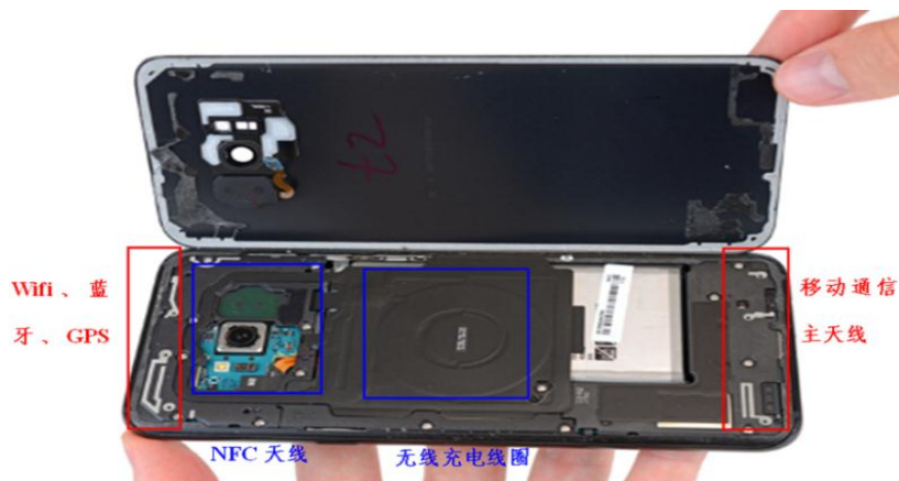
图 10：三星 S8/S8+内部天线布局
