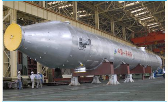
图表 30：公司的超大型换热器产品
