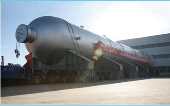
图表 29：公司生产的 1600 吨级加氢裂化反应器
