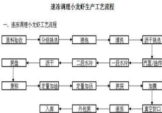
图 9：速冻预调小龙虾的生产工艺流程
